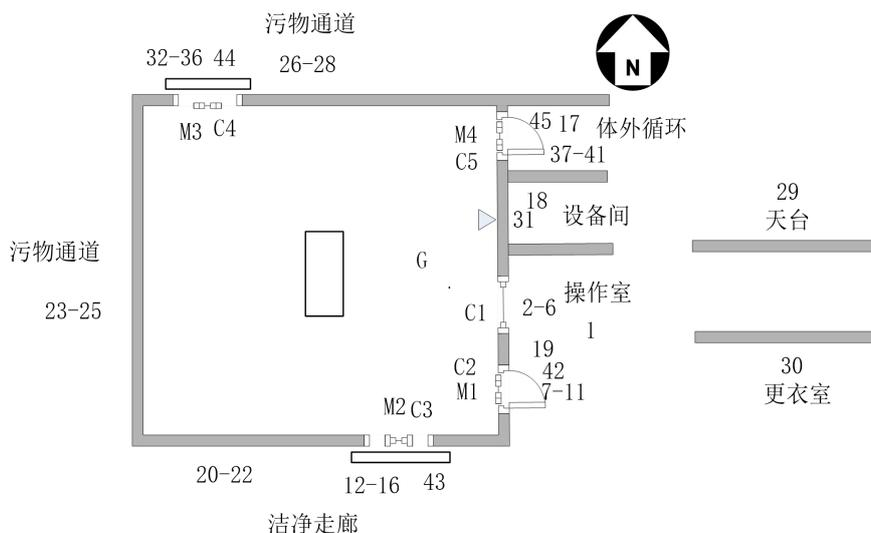
**图 6.1 DSA 机房周边 X- $\gamma$  辐射剂量当量率检测布点示意图**
